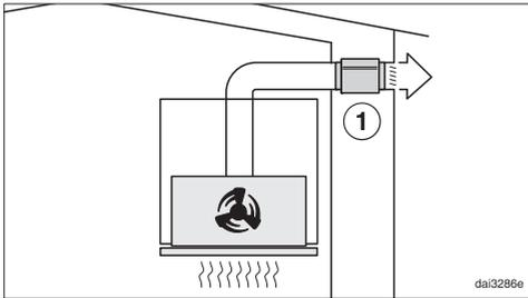
En mode évacuation, le réducteur de bruit insonorise aussi bien les bruits du ventilateur vers l'extérieur que les bruits extérieurs qui parviennent par la conduite d'évacuation (par ex. bruits des voitures). Aussi le réducteur de bruit doit être posé le plus près possible de la sortie d'évacuation d'air ①.
