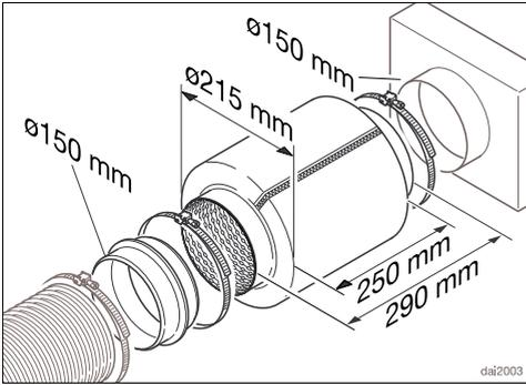
Pour amortir davantage les bruits, un réducteur de bruit peut être installé dans la conduite d'évacuation (accessoire en option).
