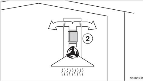
Der Schalldämpfer wird zwischen Ausblasstutzen und Umlenkstutzen positioniert ②. Der Einbaureaum ist im Einzelfall zu prüfen.
