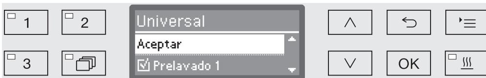
La asignación se efectúa mediante selección múltiple. En la indicación del display todos los bloques de lavado van precedidos por una casilla . Si el bloque de lavado está asignado a un programa, se verá una marca de verificación . Al seleccionar los bloques de lavado, estos se pueden asignar al programa o se puede volver a eliminar la asignación.
