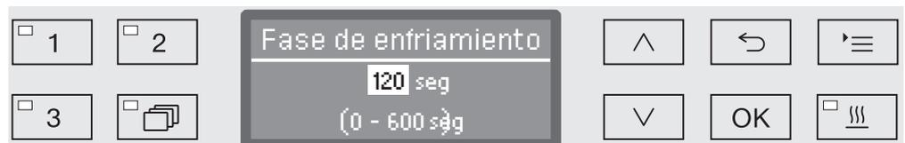
El ajuste se realiza en pasos de 10 segundos. En la línea inferior se indica el rango de ajuste permitido.
