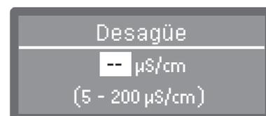
El ajuste de los valores límite se realiza en el primer paso. En la línea inferior se indica el rango de ajuste permitido.
