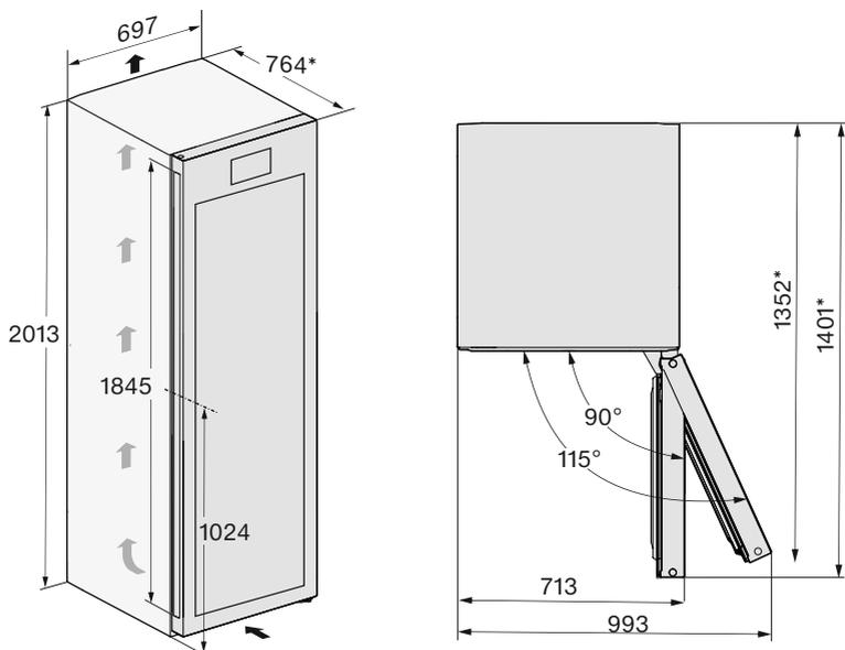
\* Dimensões sem distanciadores de parede montados. Se os distanciadores de parede fornecidos forem utilizados, a profundidade do aparelho aumenta em 15 mm.
