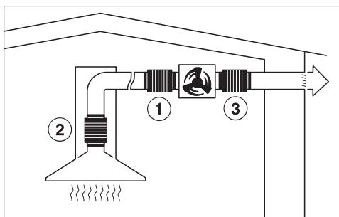
Afin de limiter au maximum les bruits de ventilation dans la cuisine, le silencieux doit être placé le plus près possible devant le ventilateur externe (1). Si le conduit d'évacuation est très long, le silencieux doit être placé sur le raccord d'évacuation de la hotte (2). Si vous utilisez un ventilateur externe installé dans la maison (ABL 202), vous pouvez limiter les bruits de ventilation en plaçant un amortisseur de bruit derrière le ventilateur externe (3).
