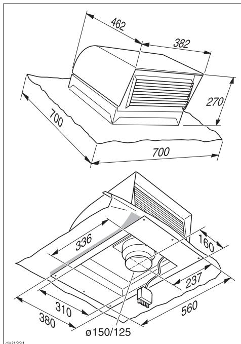
Le ventilateur de toit DDG 102 est prévu pour un montage sur toit incliné en tuile, en tuile de béton, en ardoise ou sur toit de bardage. L'inclinaison du toit doit être d'au minimum  $22^\circ$  afin qu'aucune précipitation, comme la pluie ou la neige, ne puisse pénétrer.
