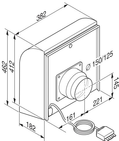
Le ventilateur mural extérieur AWG 102 est prévu pour un montage à l'extérieur du bâtiment.
