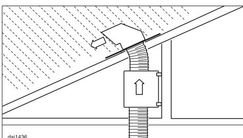
Pour le montage à la verticale du ventilateur d'évacuation et d'une conduite d'évacuation directe via la toiture, l'utilisation du passage de toit DDF 125/150 ou d'autres mesures doit permettre d'assurer qu'aucune précipitation, comme la pluie ou la neige, ne puisse pénétrer dans la sortie d'air.
