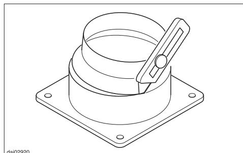
■ Pour un conduit d'évacuation Ø 150 mm, coupez l'anneau avant du raccord d'aspiration au point de rupture, avec un couteau.
