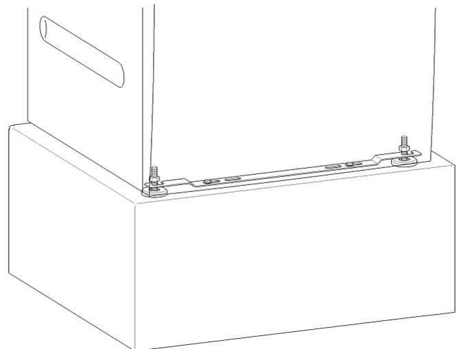
Mit dem beiliegenden Befestigungsbügel wird das Gerät über die beiden vorderen Standfüsse am Boden befestigt. Das Befestigungsmaterial ist für eine Dübel-Befestigung auf Betonboden ausgelegt.
