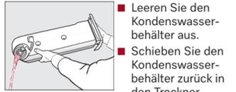
■ Halten Sie den Kondenswasserbehälter an der Griffblende und am Ende waagrecht, damit kein Wasser hinausläuft.
