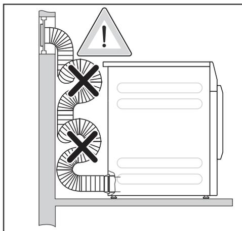
A água condensada pode correr para o secador.
