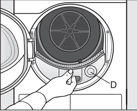
A tampa redonda (D) não tem qualquer função e não é removível.
