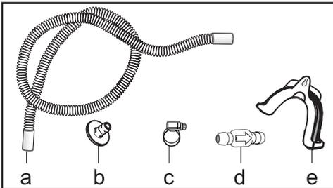
la prolongación de la manguera (a), adaptador (b), abrazadera de mangueras (c), la válvula antirretroceso (d), soporte para la manguera (e)
