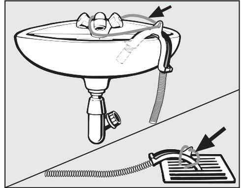
**⚠** Daños provocados porque el agua se escapa. En caso de que el final de la manguera se suelte, pueden producirse daños porque el agua se escapa. Evite que la manguera de desagüe se resbale (p. ej. atándola).
