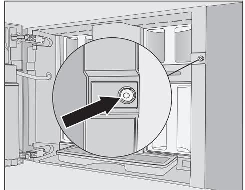
In dem Schraubenloch befindet sich eine rote Silikonkappe, die die Gerätetür während des Transports sichert und so Transportschäden am Gerät verhindert.
