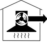
L'air aspiré passe par les filtres à graisse et est évacué vers l'extérieur du bâtiment.
