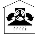
L'air aspiré est filtré par les filtres à graisse et en plus par un filtre à charbon actif. L'air est ensuite redirigé dans la cuisine.
