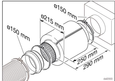
Un réducteur de bruit peut être installé dans la conduite d'évacuation d'air (accessoire en option) pour réduire davantage encore le bruit.
