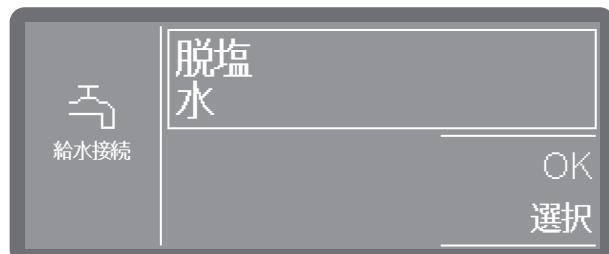
フレームは、有効な給水接続を示します。接続をタップするとフレームが消え、給水接続が永久に無効になります。
