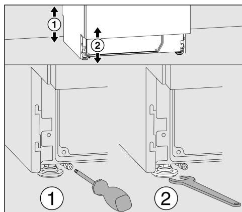
前面の機器脚は、オーブンスパナ(スパナサイズ13)で調整可能です。後部の脚はT20トルクスネジで調整してください。
