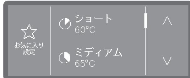
■ ^およびvセンサコントロールを使用してプログラムリストをスクロールし、選択したお気に入りスペースに表示させたいプログラムを選択します。
