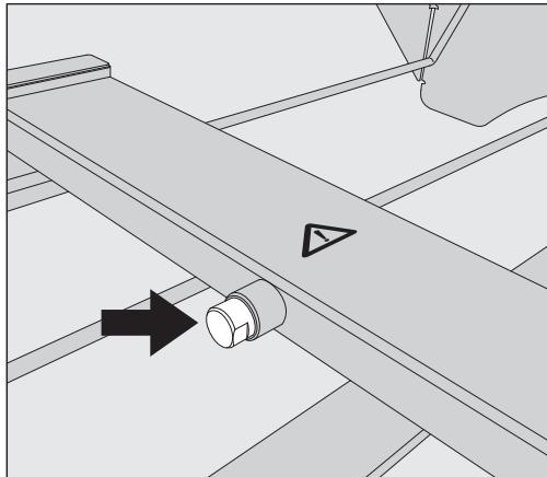
■ 洗浄圧力を測定するには、ブラインドストッパーをルアーロックアダプターに交換します。
