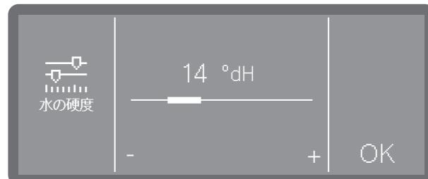
■ -記号(低)と+記号(高)をタップして、水硬度レベルを設定します。
