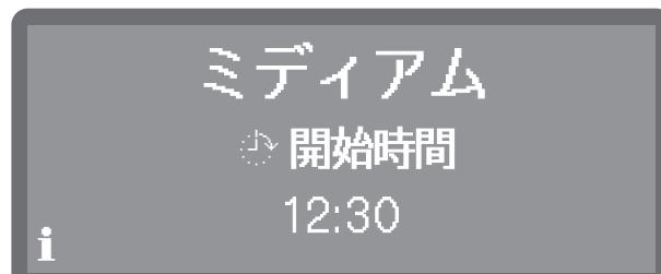
これによりタイマーが起動します。最後の入力から一定時間が経過すると、洗浄機はプログラムが開始されるまでスタンバイモードに切り替わります。
