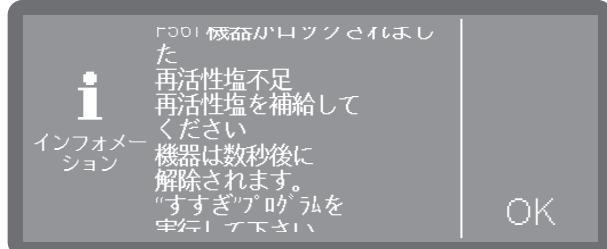
■ ディスプレイの指示に従い、再活性塩を補充します(□i 「再活性塩コンテナの充填」を参照)。塩を補充すると、一定時間の遅延後に機器のロックが自動的に解除されます。
