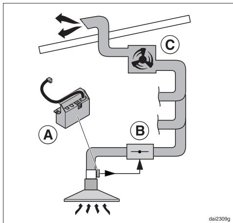
Styrellektronikens potentialfria kontakt (A) kan till exempel användas för en fläkt i modellserien ... EXT/EXTA, som är ansluten till en centraluppsugning. Kontakten kan användas till att aktivera en eldriven spärrventil (B), som är förkopplad till centraluppsugningen.
