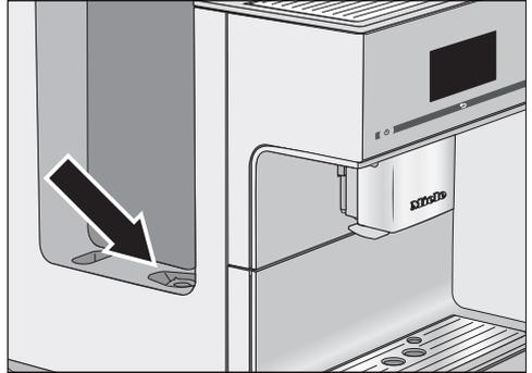
Le filtre du réservoir eau se trouve sous le réservoir.
