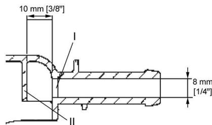
Beachten Sie, dass nur die erste Wand (I) durchbohrt werden darf, da sich bereits 10 mm hinter der ersten Wand eine Prallwand (II) befindet.
