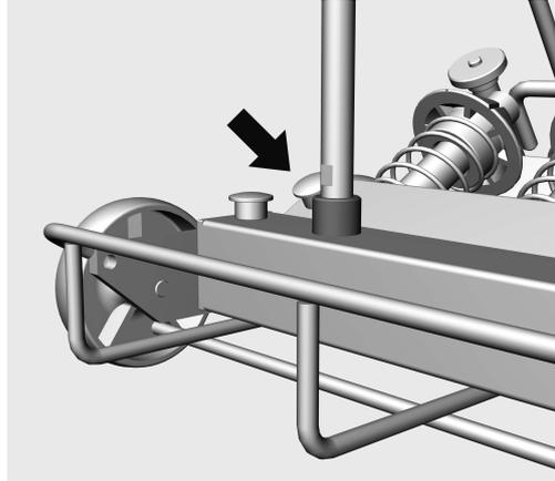
L'ouverture à gauche de la barre à injection avant sert d'accès de mesure de la pression de lavage. Il a été établi dans le cadre du contrôle des performances et des validations en conformité avec la norme EN ISO 15883 que la pression de lavage pouvait être mesurée à cet endroit.
