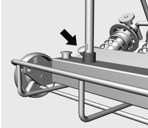
Den venstre holder i forreste injektorliste anvendes som indgang til måling af spuletryk. Som led i afprøvninger af effekt og valideringer iht. EN ISO 15883 kan spuletrykket måles ved denne indgang.
