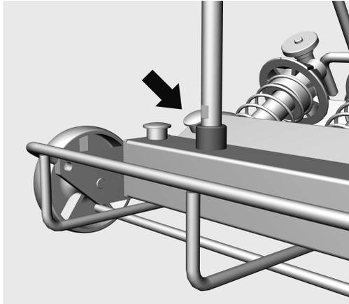
El alojamiento izquierdo de la regleta inyectora delantera sirve de acceso para la medición de la presión de lavado. En el contexto de las comprobaciones de potencia y validaciones conformes a la norma EN ISO 15883, en dicho acceso es posible medir la presión de lavado.
