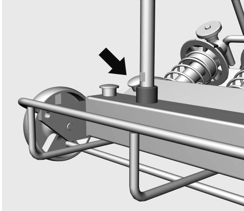
De linker houder in de voorste injectoreenheid dient als toegang voor de spoeldrukmeting. In het kader van prestatietests en validaties conform EN ISO 15883 kan via deze toegang de spoeldruk worden gemeten.
