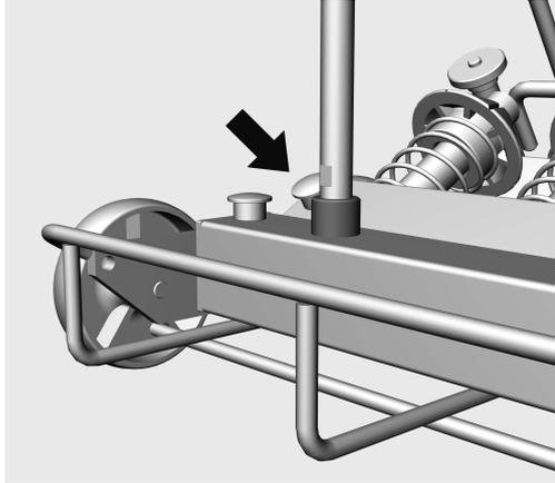
Die linke Aufnahme in der vorderen Injektorleiste dient als Zugang für die Spüldruckmessung. Im Rahmen von Leistungsprüfungen und Validierungen gemäß EN ISO 15883 kann an diesem Zugang der Spüldruck gemessen werden.
