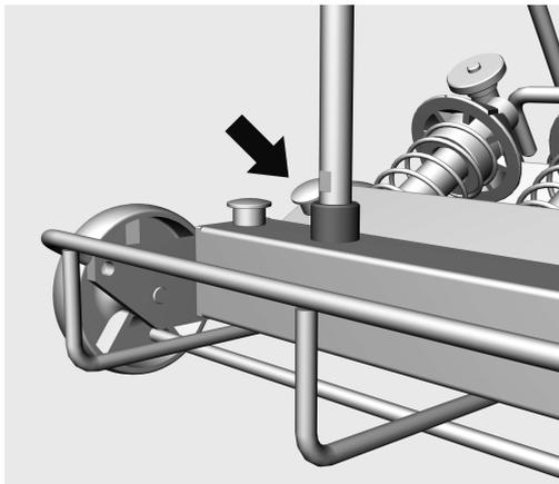
Lijevi prihvat u prednjoj injektorskoj letvici služi kao pristup za mjerenje tlaka pranja. U okvirima ispitivanja učinka i validacije prema EN ISO 15883 može se na ovom pristupu izmjeriti tlak pranja.
