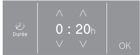
Effleurez les flèches  $\wedge$  et  $\vee$  et confirmez avec la touche sensitive OK.
