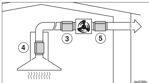
При работа с външен вентилатор, шумът от вентилатора навън и в кухнята може да бъде сведен до минимум.
