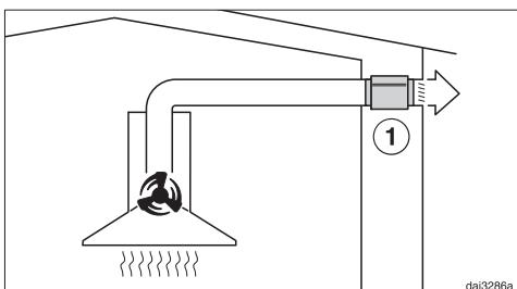
В режим на отвеждане на въздуха, шумозаглушителят заглушава както шумовете от вентилатора навън, така също и външните шумове, които нализат в кухнята през тръбата за отвеждане на въздуха (напр. уличен шум). За целта шумозаглушителят се позиционира възможно най-близо пред изхода на отработения въздух ①.
