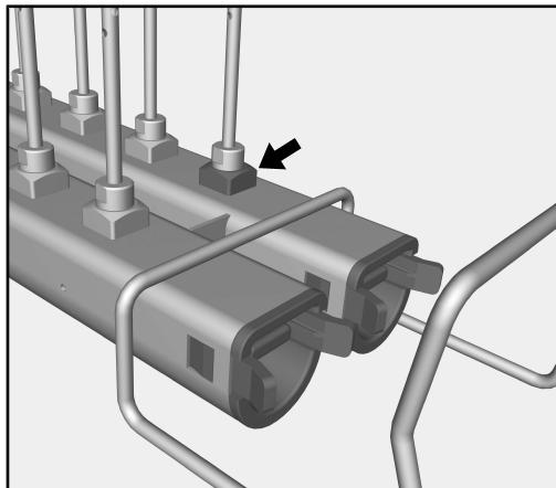
오른쪽 인젝터 레일 상단의 홀더가 수압 측정을 위한 테스트 포인트로 사용됩니다. 이 연결 지점은 EN ISO 15883에 따라 성능 및 유효성 테스트 측면에서 세척 압력 테스트에 사용할 수 있습니다.
