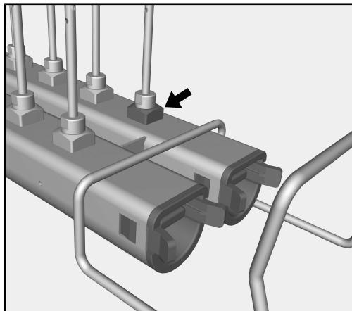
Suportul aflat în poziţia cea mai din faţă în bara de injectare din dreapta are şi rolul de punct de măsurare a presiunii de spălare. În cadrul verificărilor de performanţă şi validărilor conform EN ISO 15883, presiunea de spălare poate fi măsurată în acest punct.
