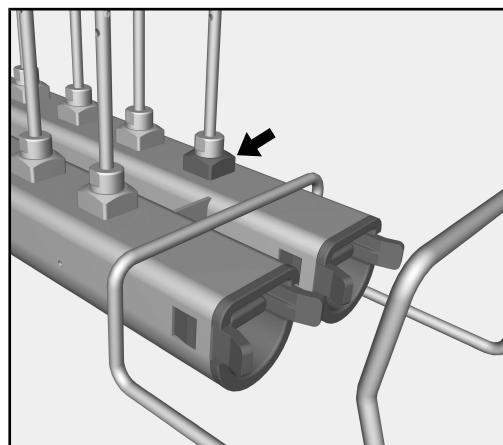
右侧喷射轨道顶端的支架用作测量水压的测试点。该接点可用于测试性能框架内的清洗压力以及根据 EN ISO 15883 验证测试。
