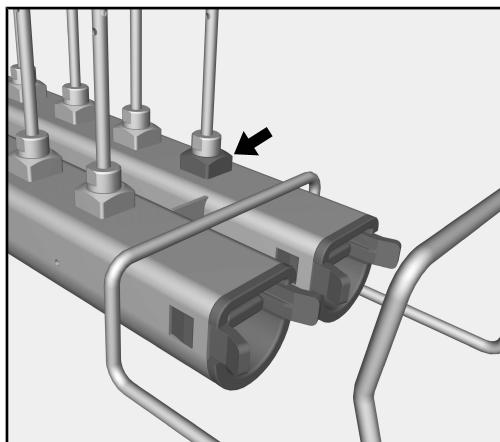
右側のインジェクターレールの上部のホルダーは、水圧を測定するためのテストポイントとして使用されます。この接続点は、EN ISO 15883に準拠した性能やバリデーション試験のフレームワーク内で洗浄圧力を試験するために使用することができます。
