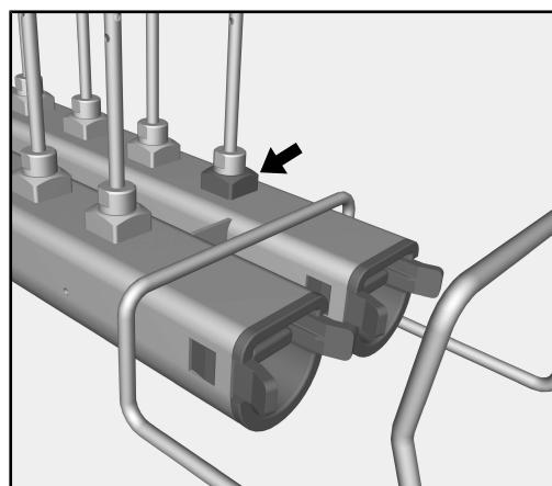
Držák úplně vpředu na pravé injektorové liště slouží jako přístup pro měření mycího tlaku. V rámci výkonových zkoušek a validací podle EN ISO 15883 lze na tomto přístupu měřit mycí tlak.
