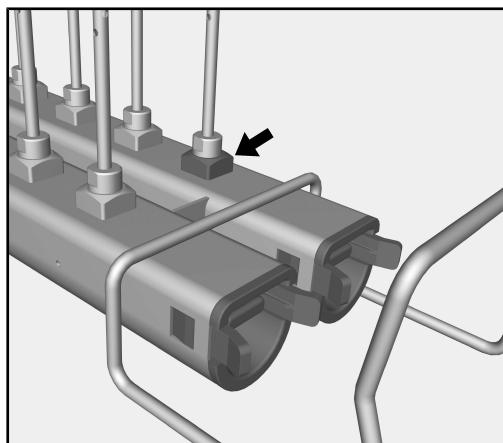
Η μπροστινή υποδοχή της δεξιάς δοκού εκτοξευτήρων εξυπηρετεί ως πρόσβαση για τη μέτρηση της πίεσης πλύσης. Στο πλαίσιο των ελέγχων απόδοσης και πιστοποιήσεων σύμφωνα με το EN ISO 15883, η πίεση ξεβγάλματος μπορεί να μετρηθεί σε αυτή την πρόσβαση.
