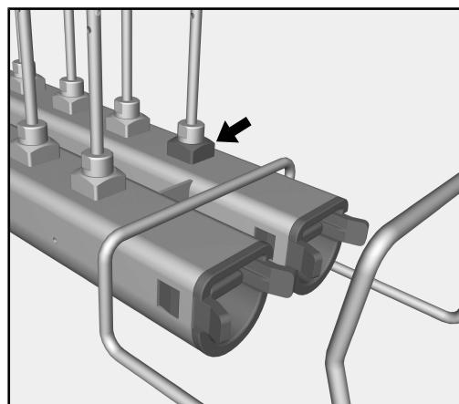
Ближайшее к переднему краю гнездо правой инжекторной панели используется в качестве доступа для измерения давления промывки. В рамках проверок эффективности и валидации в соответствии со стандартом EN ISO 15883 на этом подсоединении можно измерить давление промывки.
