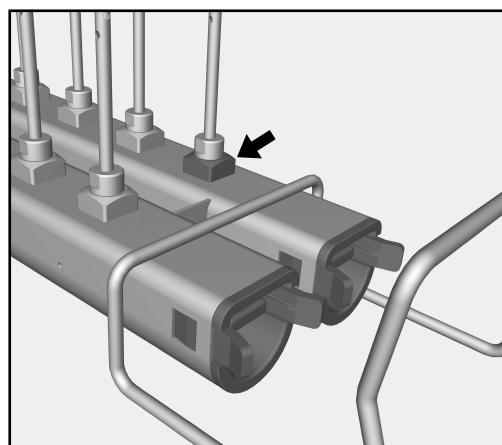
Sağ enjektör modülünün en öndeği yuvası, yıkama suyu basıncı ölçümü için giriş yeri olarak kullanılır. EN ISO 15883 uyarınca gerçekleştirilen performans kontrolleri ve validasyonlar çerçevesinde bu girişte yıkama suyu basıncı ölçülür.
