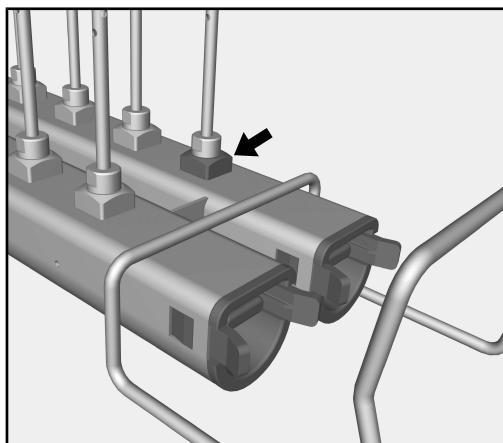
Pierwsze gniazdo prawej listwy iniekcyjnej służy jako dostęp do pomiaru ciśnienia mycia. W ramach kontroli wydajnościowych i validacji zgodnie z EN ISO 15883 na tym przyłączu można zmierzyć ciśnienie mycia.
