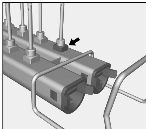
Držiak úplne vpredu na pravej injektorovej lište slúži ako prístup na meranie umývacieho tlaku. V rámci testov výkonu a validácie podľa EN ISO 15883 je možné na tomto prístupe merať umývací tlak.
