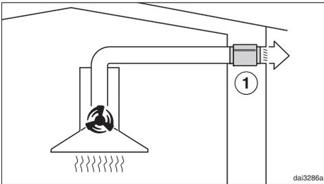
Κατά τη λειτουργία εξαγωγής του αέρα ο σιγαστήρας εξασθενίζει τόσο τους θορύβους της τουρμπίνας μεταφέροντάς τους προς τα έξω, καθώς και τους εξωτερικούς θορύβους οι οποίοι εισέρχονται μέσω του αγωγού εξαγωγής αέρα στην κουζίνα (π.χ. θόρυβοι από τον δρόμο). Για αυτόν τον λόγο, ο σιγαστήρας τοποθετείται όσο το δυνατόν πιο κοντά στο σημείο εξαγωγής του αέρα ①.
