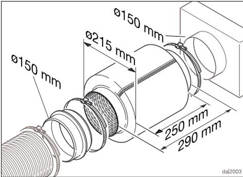
Για πρόσθετη ηχομόνωση μπορεί να τοποθετηθεί ένας σιγαστήρας στον αγωγό εξαγωγής αέρα (πρόσθετο εξάρτημα).
