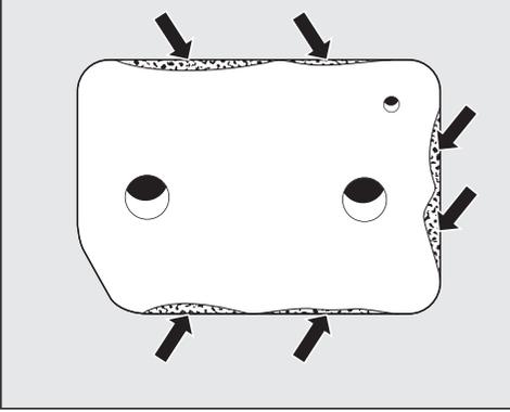
⚠ Dommages provoqués par un filtre de socle endommagé ou usé. L'échangeur thermique est encrassé et peut être endommagé. Vérifiez le filtre de socle conformément à la section "Remplacer le filtre de socle" au chapitre "Correction des problèmes". Remplacez le filtre de socle, si nécessaire.
