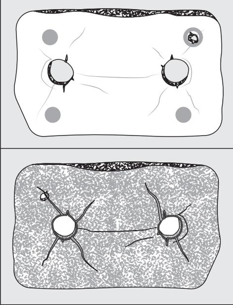
Les fentes, fissures et marques sont visibles sur les faces avant et arrière.
