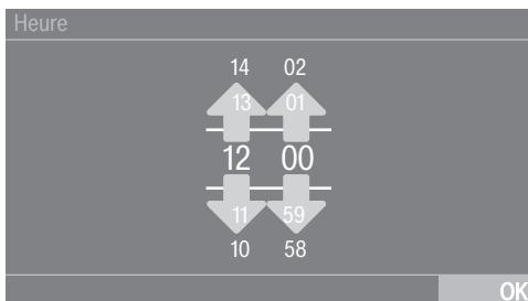
Entrez les chiffres en glissant vers le haut ou vers le bas. Posez le doigt sur le chiffre à modifier et glissez-le dans la direction souhaitée. Pour valider la valeur numérique réglée, effleurez la touche sensitive *OK*.
