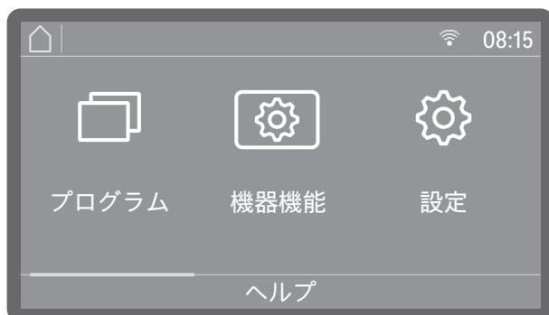
機器がネットワークに接続されている場合、ディスプレイの上部に利用可能なインターフェイスのアイコンが表示されます。通常是WiFi接続、通常是有線LAN接続を表します。機器がWiFiルーターとの WiFi接続を確立できない場合、署線で表示されます。
