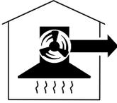
Die angesaugte Luft wird durch die Fettfilter gereinigt und aus dem Gebäude geleitet.
