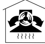
Die angesaugte Luft wird durch die Fettfilter und zusätzlich durch einen Geruchsfilter gereinigt. Anschließend wird die Luft in die Küche zurückgeführt.
