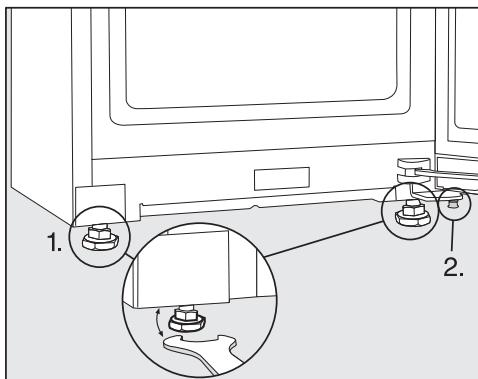
■ Выровняйте прибор с помощью уровня и прилагаемого гаечного ключа и подоприте дверцу.
