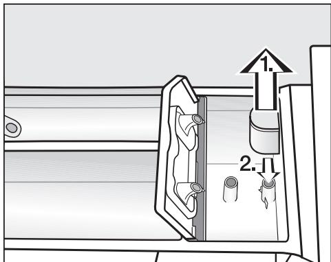
1. Trekk ut sugeheverten fra kammer ☘ og rengjør under rennende varm vann. Rengjør også røret som sugeheverten settes på.
