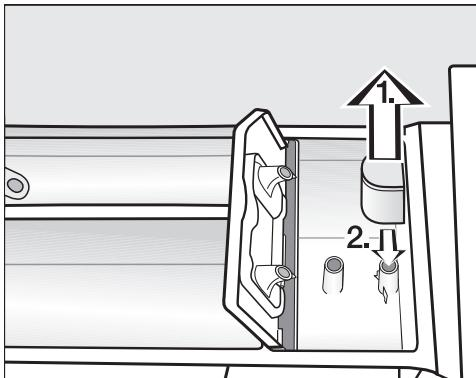
1. Scoateți sifonul din compartimentul
