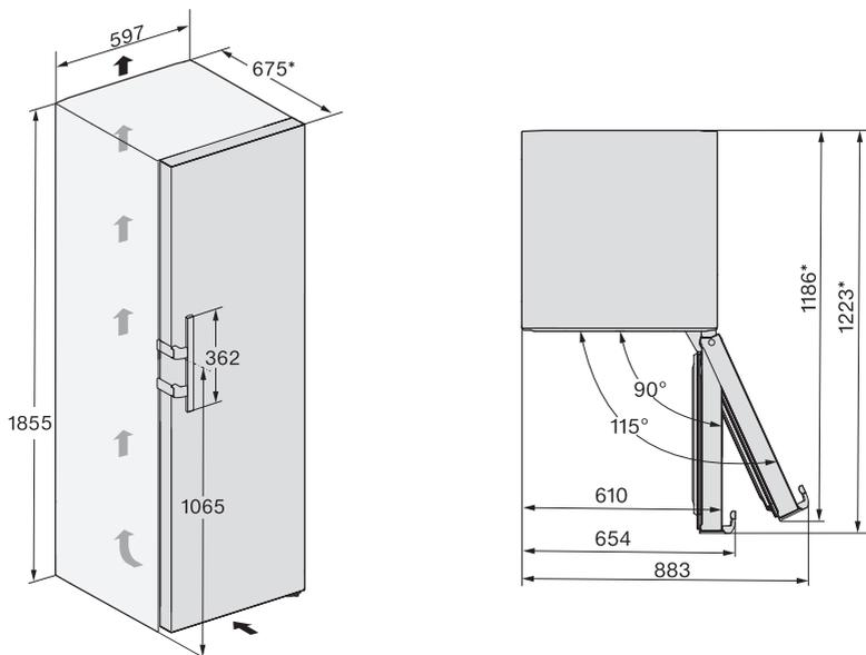
\* Misura senza distanziatori da parete montati. Se si montano i distanziatori in dotazione, la profondità dell'apparecchio aumenta di 15 mm.
