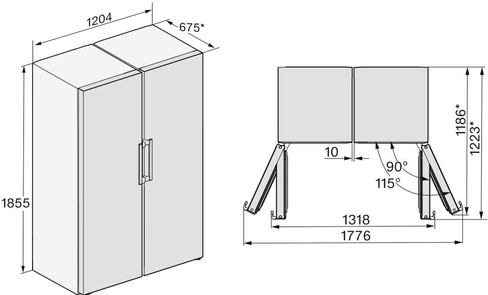
\* Misura senza distanziatori da parete montati. Se si montano i distanziatori in dotazione, la profondità dell'apparecchio aumenta di 15 mm.
