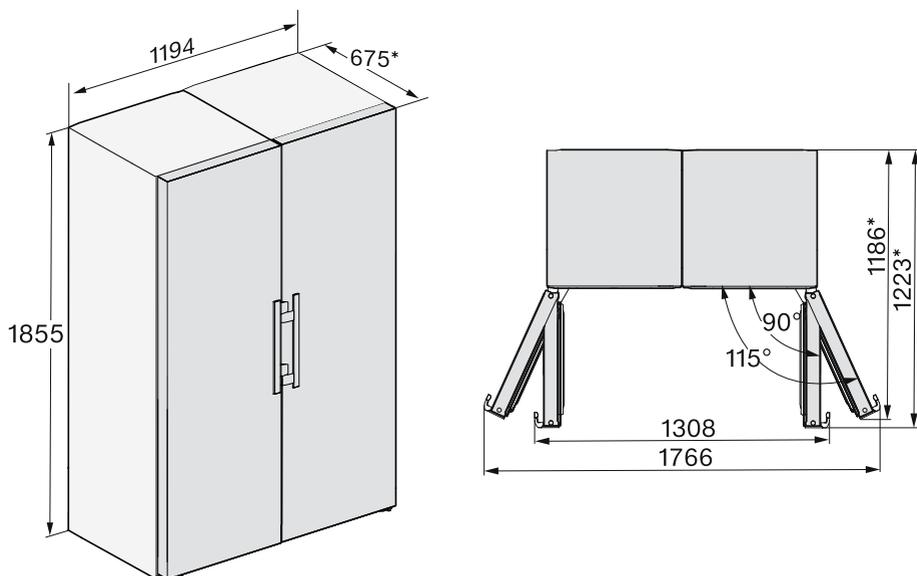
\* Misura senza distanziatori da parete montati. Se si montano i distanziatori in dotazione, la profondità dell'apparecchio aumenta di 15 mm.
