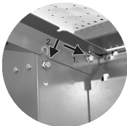
Installation de la table de sortie sur le montant gauche
