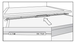
■ Schieben Sie den Fachdeckel bis zum Anschlag nach hinten.
