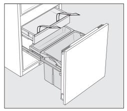
■ Fassen Sie die Schublade seitlich im hinteren Bereich an und heben Sie sie erst nach oben und dann nach vorne ab.
