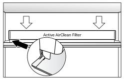
Setzen Sie die Halterung auf die Schutzleiste.
