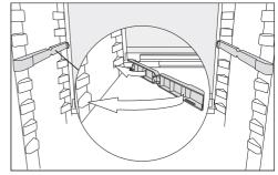
Stecken Sie die beiden Adapter in gewünschter Höhe links und rechts auf die Auflagerippen.
