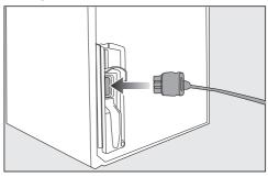
■ Stecken Sie den Gerätestecker auf der Rückseite des Kältegeräts ein.
