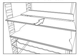
Heben Sie die vordere halbe Glasplatte vorn leicht an und schieben Sie die Glasplatte vorsichtig unter die hintere Hälfte.
