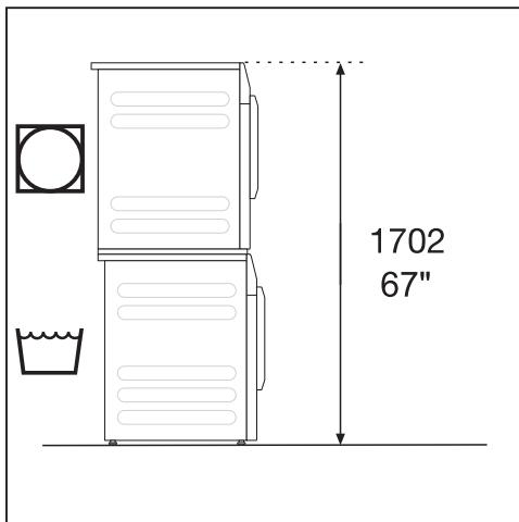
La machine à laver peut être superposée à une sécheuse Miele. Pour cela, il faut un kit de superposition (APCL 001, accessoire en option).
