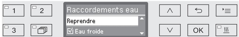
Le réglage des raccordements à l'eau doit faire l'objet d'une sélection multiple. A l'écran, chaque raccordement à l'eau est suivi d'un petit carré  qui apparaît coché  en cas d'activation du raccordement correspondant. Il est possible d'activer ou de désactiver tous les raccordements à l'eau.
