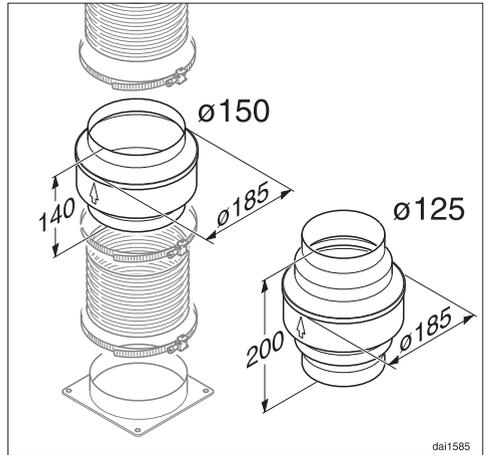
Neben einer entsprechenden Isolation der Abluftleitung ist die Installation einer Kondenswassersperre empfehlenswert, die das anfallende Kondenswasser aufnimmt und verdunstet.
