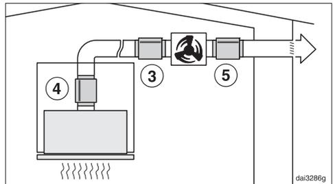
Um Gebläsegeräusche in der Küche zu minimieren, ist der Schalldämpfer möglichst vor dem externen Gebläse zu positionieren ③, bei einer langen Abluftleitung am Abluftstutzen der Dunstabzugshaube ④. Bei einem externen Gebläse, das im Haus montiert ist, ist durch Einsatz eines Schalldämpfers hinter dem externen Gebläse ⑤ eine Verringerung der Gebläsegeräusche nach aussen möglich.
