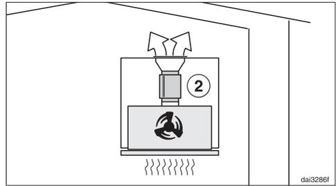
Der Schalldämpfer wird zwischen Ausblasstutzen und Ausblaspitter positioniert ②. Der Einbauraum ist im Einzelfall zu prüfen.
