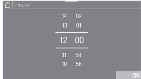
Entrez les chiffres en glissant vers le haut ou vers le bas. Posez le doigt sur le chiffre à modifier et glissez-le dans la direction souhaitée. Pour valider la valeur chiffrée réglée, effleurez la touche sensitive OK.
