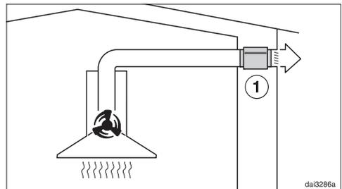
En mode évacuation, le réducteur de bruit insonorise aussi bien les bruits du ventilateur vers l'extérieur que les bruits extérieurs qui parviennent par la conduite d'évacuation d'air (par ex. bruits des voitures). Aussi le réducteur de bruit doit être posé le plus près possible de la sortie d'évacuation d'air ①.
