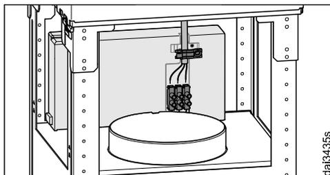
Pour un raccordement irréprochable, la décharge de traction existante doit être utilisée.
