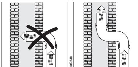
Si l'air doit être évacué dans une cheminée d'évacuation, le manchon d'entrée doit être orienté dans le sens du flux d'air.
