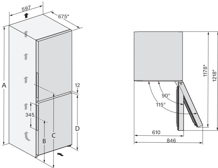
\* 未安装墙壁隔垫时的尺寸。安装提供的适配隔垫后，本电器的深度增加了15 毫米。
