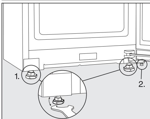
■ 使用所提供的水平仪和开口扳手，对准制冷电器并支撑电器机门。
