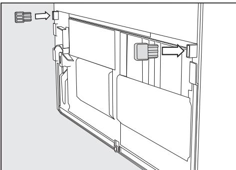
■ Τοποθετήστε τους αποστάτες τοίχου στην πίσω πλευρά της συσκευής κάτω αριστερά και κάτω δεξιά.
