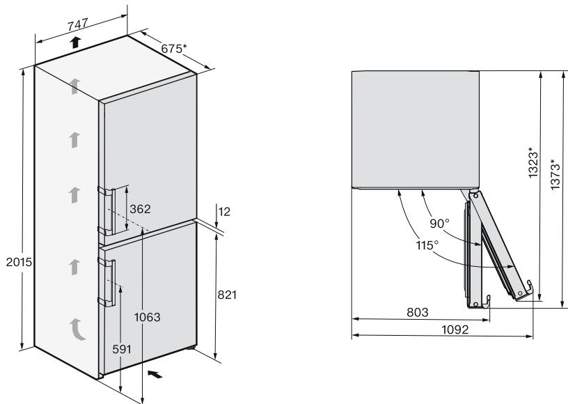
\* Διαστάσεις χωρίς τοποθετημένους αποστάτες τοίχου. Αν χρησιμοποιηθούν οι συνοδευτικοί αποστάτες τοίχου, το βάθος της συσκευής αυξάνεται κατά 15 mm.
