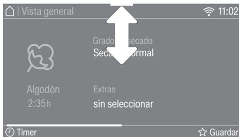
Toque con el dedo en el centro del marco superior de la pantalla y desplácelo hacia abajo, tapando el display.
