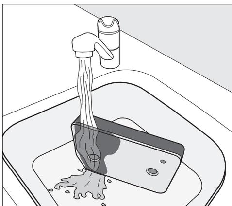
**Conseil :** Pour que les résidus présents sur la surface se détachent plus rapidement, faites passer un jet d'eau à la verticale sur la face avant du filtre de socle.
