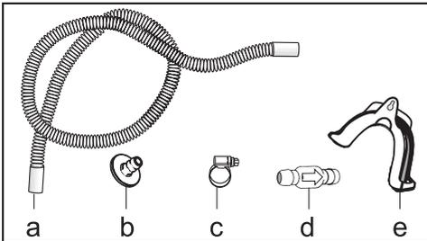
la rallonge de tuyaux (a), adaptateur (b), collier de serrage (c), le clapet anti-retour (d), support de tuyau (e)
