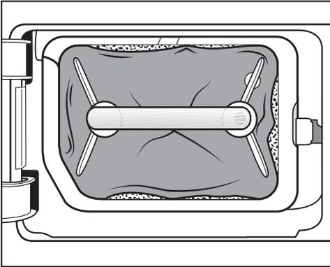
Les bords du filtre de socle ne sont pas en contact et le filtre de socle est déformé. Les peluches passent au niveau des bords et sont entraînées dans l'échangeur thermique. À la longue, l'échangeur thermique s'encrasse.
