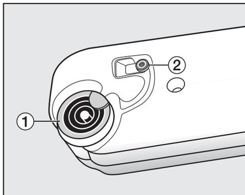
**1** Raccord d'écoulement, **2** Joint en caoutchouc
