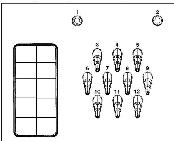
Les raccords **1** et **2** sont fournis pour les produits visqueux. Ces raccords sont scellés et doivent être percés à l'aide d'un foret de 8 mm avant tout raccordement.
