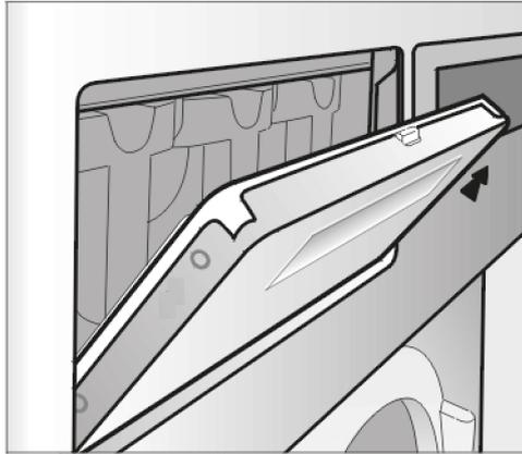
Si la rainure d'égouttage et le raccordement d'évacuation associé sont bloqués, nettoyez-les.
