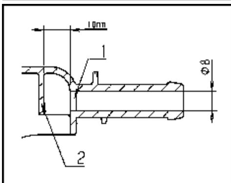
Il est important de percer la première paroi (1) avec précaution de sorte à ne pas toucher la paroi déflectrice (2) qui se trouve 10 mm (3/8") derrière.
