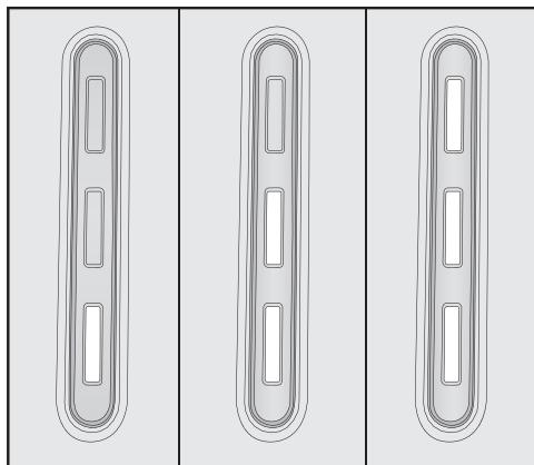
Wenn der Akku lange nicht genutzt wurde und entladen ist, fällt er in einen Sicherheitsmodus. Beim Laden in der PowerUnit reagiert die Anzeige Akku-Ladezustand dann erst nach ca. 30 - 60 Minuten.
