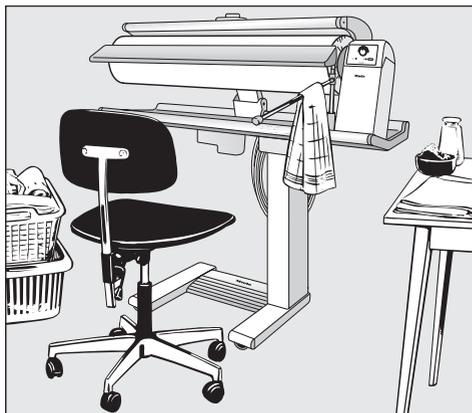
Certifique-se de que a calandra se encontra numa posição nivelada para garantir uma saída uniforme do vapor. Assegure estabilidade suficiente para não escorregar lateralmente.
