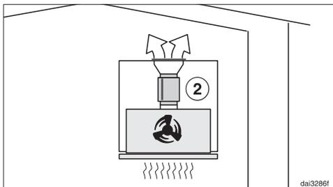
No modo de circulação de ar, o silenciador é posicionado entre a válvula de segurança e a grelha ②. Verifique o espaço de montagem.
