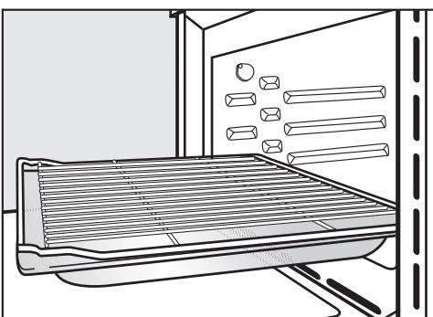
■ Za određene postupke pečenja (npr. za pečenje na rešetki) stavite rešetku zajedno sa staklenom tacnom. Samo tako se zaštita od izvlačenja nalazi napred.
