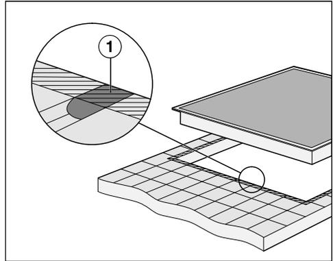
► Las ranuras ① y la zona rayada situada por debajo de la superficie auxiliar de la placa de cocción deberán ser lisas y regulares para que la placa de cocción asiente de forma homogénea y la junta por debajo del borde de la parte superior del aparato garantice el sellado con la encimera.
