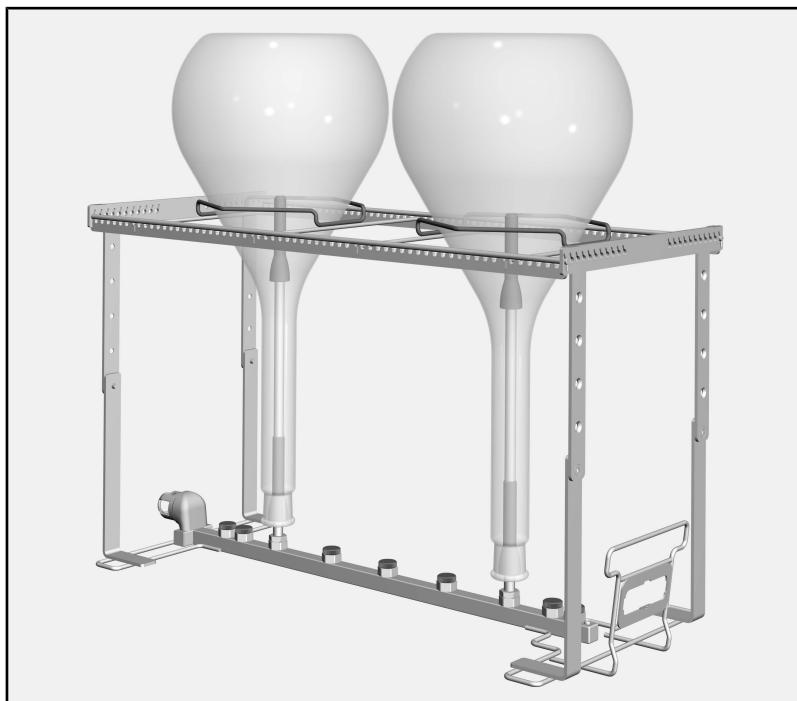
Os balões graduados são imobilizados no apoio na armação de suporte do módulo.
