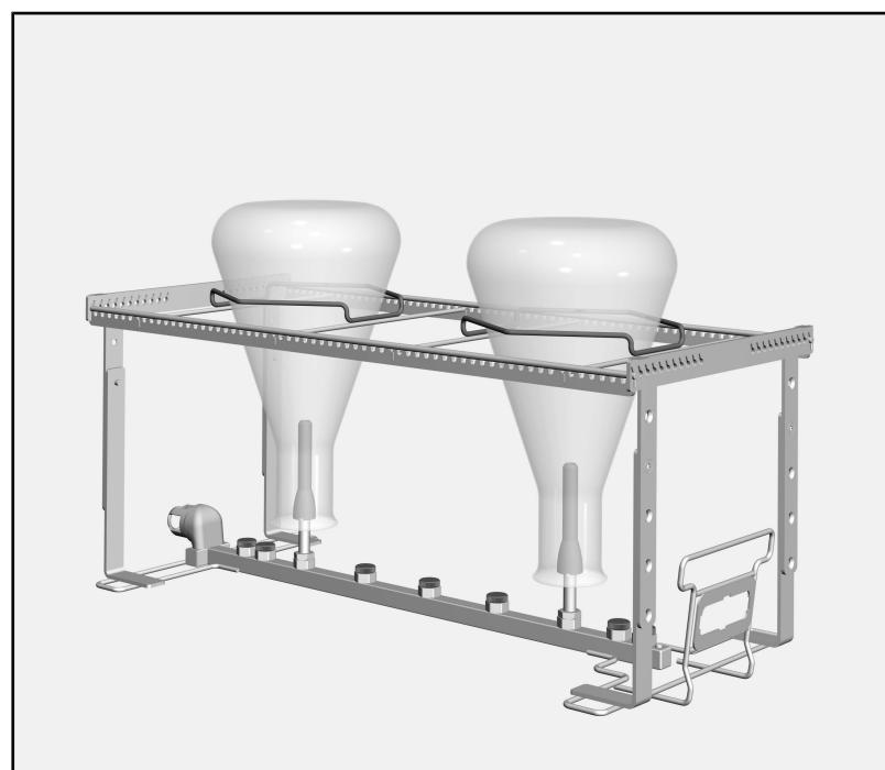
Erlenmeyerkolvorna ligger på en hållare i modulens hållarram.
