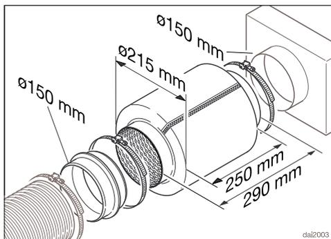
En la conducción de salida de aire se puede colocar un silenciador (accesorios especiales).
