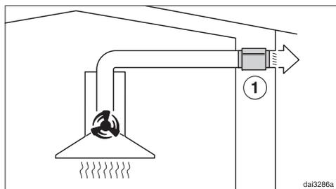
El silenciador amortigua tanto los ruidos del ventilador hacia fuera como los ruidos exteriores que entran en la cocina a través de la conducción de salida de aire (p. ej. el ruido de la calle). Para ello, el silenciador se coloca lo más cerca posible de la salida de aire (1).
