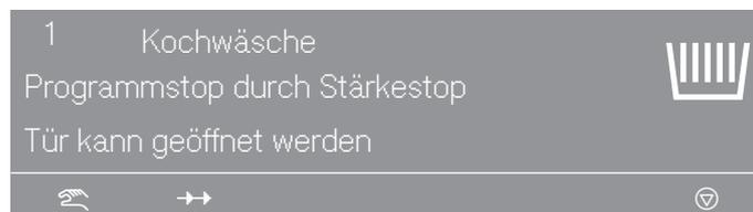
Wird der Programmschritt "Stärkestop" erreicht, blinkt im Display Programmstop durch Stärkestop.
