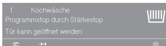
Taste "START" betätigen und das Programm wird fortgesetzt.
