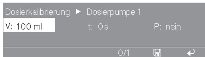
**Tipp:** Die Dosiermenge ist einstellbar von 0 bis 9999 ml in 1 ml-Schritten.
