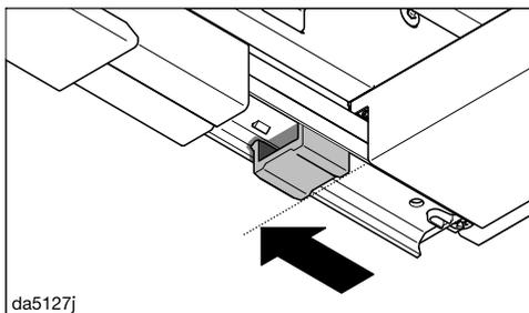
■ Schieben Sie die Tiefenanschläge bis zur gezeigten Position nach vorne.
