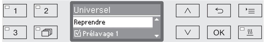
Une liste à choix multiples permet d'affecter un bloc de lavage à un programme. Chaque bloc de lavage est précédé d'une petite case , qui sera cochée dans le cas du bloc de lavage sélectionné . Le fait de sélectionner un bloc de lavage permet soit de l'affecter au programme soit d'en retirer l'affectation.
