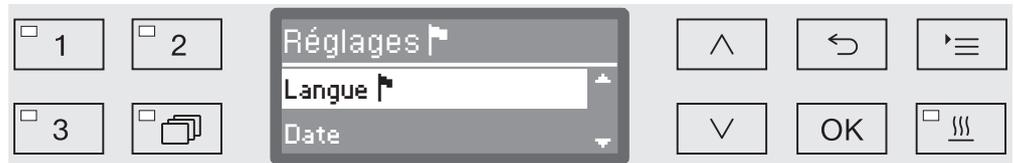
Les flèches de navigation  $\wedge$  et  $\vee$  du panneau de commande permettent de naviguer dans le menu.
