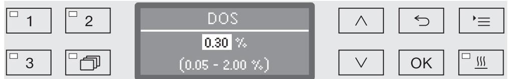
Le réglage s'effectue par paliers de 0,01 %. Sur la dernière ligne du bas s'affiche la plage de réglage possible. Tenez compte des recommandations de la concentration du fabricant de produits.
